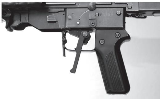
Figure 22: Détente d'hiver pour tireurs gauchers pour F ass 57
