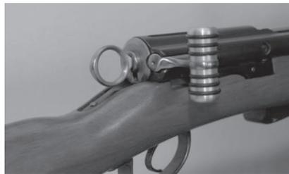
Figure 30: Poignée de verrou anatomique pour mousqueton et fusil
