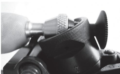
Figure 5: Système de filtres colorés Wyss emboîté
