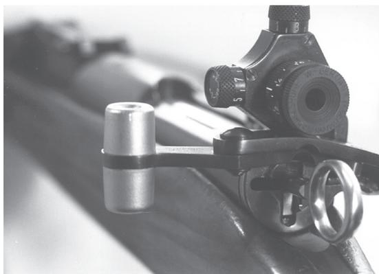
Figure 26: Verrou à gauche pour mousqueton 31
