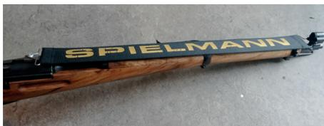
Figure 31: Bande anti-scintillement pour mousqueton
